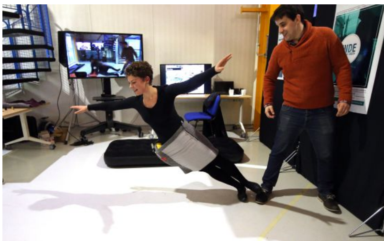
Una de las estudiantes de CBI prueba el prototipo de falda con airbag, que funciona con una pequeña cápsula de gas como la de los chalecos salvavidas / ULY MARTÍN (EL PAÍS)
