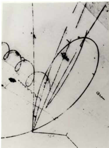
Fotografía, en la una cámara de burbujas, de las dos primeras partículas encantadas. / BROOKHAVEN NATIONAL LABORATORY
