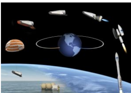
Esquema del vuelo de prueba del vehículo espacial IXV: lanzamiento en un cohete Vega (derecha) en Guyana Francesa, separación del mismo, vuelo autónomo y descenso con paracaídas hasta el Pacífico (izquierda), en total unos 100 minutos. / ESA
